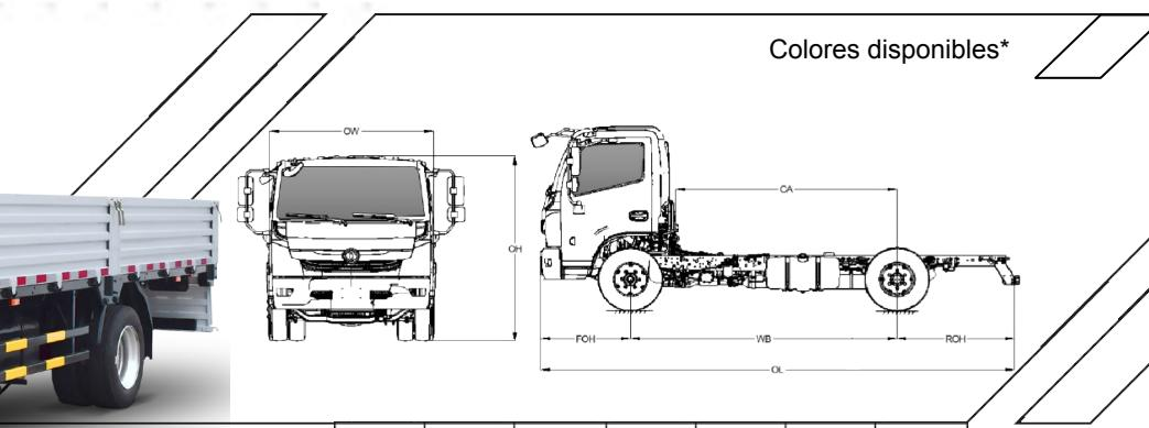
OL Largo (mm), OW Ancho total (mm), OH Altura total (mm), WB Distancia entre ejes (mm), FOH Voladizo delantero (mm), ROH Voladizo trasero (mm), CA Longitud de cabina al eje (mm).
